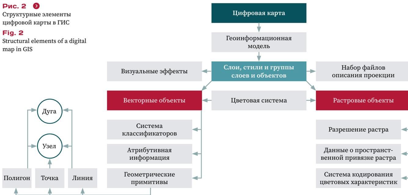
Структурные элементы цифровой карты, созданной в ГИС, формируют визуально-графическую, послойную, топологическую структурные модели и модель базы геоданных.
