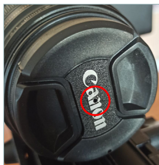
Рис. 4 ⬇ Внешняя диафрагма из крышки для объектива
